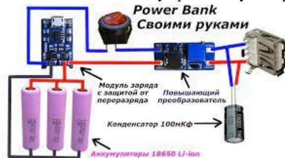
В своей схеме я использую один аккумулятор и не использую конденсатор.
